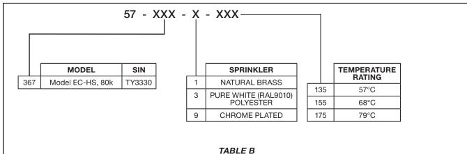
SERIES EC-HS EXTENDED COVERAGE HORIZONTAL SIDEWALL SPRINKLERS PART NUMBER SELECTION
